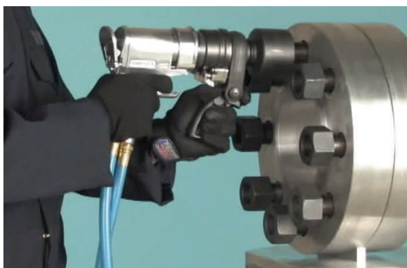
TorcGun Flip nopea-asennossa kiertää löysät pois
