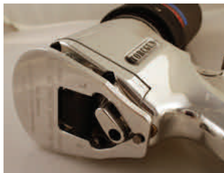
TorcGun työkalun perällä on "Safety Paddle" turvavyötkin.
