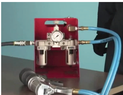
Momentti säädetään paineilmasäätimellä työkalun mukana toimitettavan taulukon mukaisesti.
