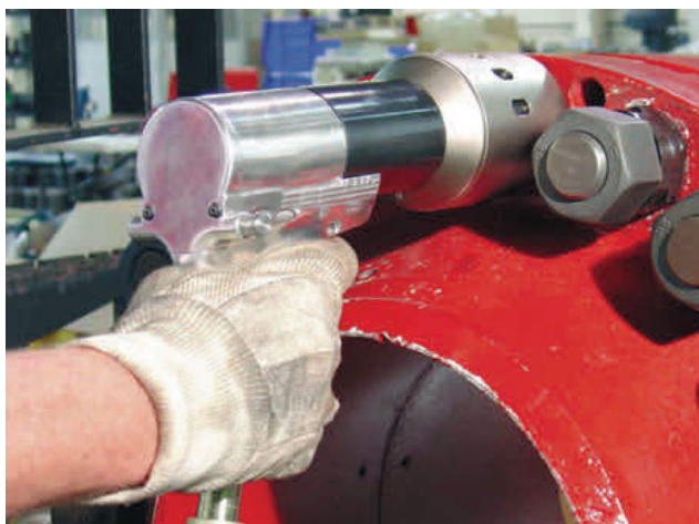
TorcGun toimii myös yhdessä HYTORC Washer—aluslevyn kanssa.
