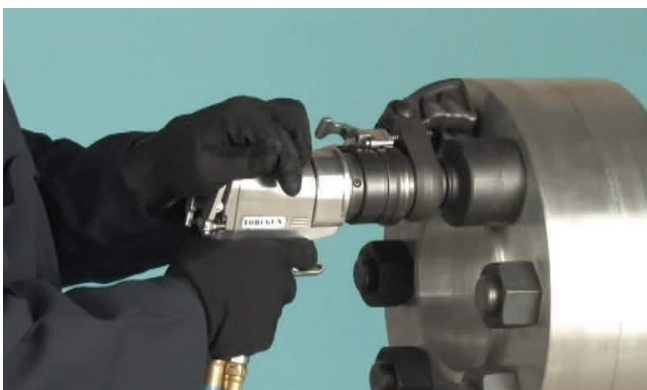
TorcGun Flip kiristämässä momenttiin
