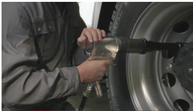
Pidennysosalla yltää helposti raskaan kaluston pultteihin
